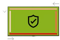
La función de desplazamiento de píxeles se puede activar para reducir el riesgo potencial de que la imagen se pegue cuando se muestra contenido estático durante largos períodos de tiempo. La función cambia periódicamente la imagen en la pantalla, sin causar interferencia de la experiencia visual.
