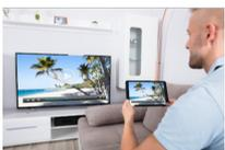
Puede controlar su TV de hospitalidad con sus dispositivos móviles de forma inalámbrica. Es posible enviar contenido multimedia desde sus dispositivos a su televisor para verlos en una pantalla de TV grande. La tecnología Miracast & Wireless Display proyecta su pantalla móvil completa simultáneamente, mientras que DLNA solo permite proyectar contenidos multimedia.
