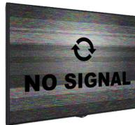
Nuestro software SoC tiene una protección para el escenario "sin señal". Si el USB se desenchufa después de configurar el contenido para que se muestre con USB, la pantalla mostrará su pancarta personalizada o buscará cualquier otra señal de otras fuentes (HDMI, Puerto de pantalla, etc.). Esta protección contra fallas está construida para una mayor experiencia del usuario.
