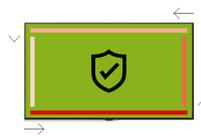
Die Pixel-Shifting-Funktion kann aktiviert werden, um das potenzielle Risiko von Image-Sticks zu verringern, wenn statische Inhalte über einen längeren Zeitraum hinweg angezeigt werden. Die Funktion verschiebt das Bild in regelmäßigen Abständen auf dem Display, ohne das visuelle Erlebnis zu beeinträchtigen.
