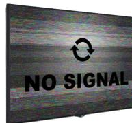
Unsere SoC-Software schützt Sie vor dem Fall, kein Signal zu empfangen. Falls der Inhalt nicht über die ausgewählte Verbindung USB angezeigt wird, greift das Display auf ein kundenspezifisches Banner zurück oder sucht ein Signal aus einer anderen Quelle (HDMI, Display Port, etc.). Diese Absicherung sorgt für eine höhere Benutzerfreundlichkeit.
