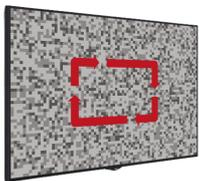
Für den Schutz vor potenziellen Risiken des Image-Stickings, welches durch konstante Inhalte verursacht wird, wird innerhalb des SoCs das Pixel Shifting aktiviert. Hierbei bewegen sich die Pixel auf dem Bildschirm in einem Intervall, ohne das Seherlebnis zu beeinträchtigen.
