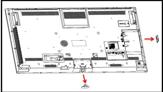
SHOWN LOGO PLATE (BOTTOM / RIGHT POSITION) SHOULD BE DISASSEMBLED. PLEASE KEEP SCREWS FOR FURTHER USE.
