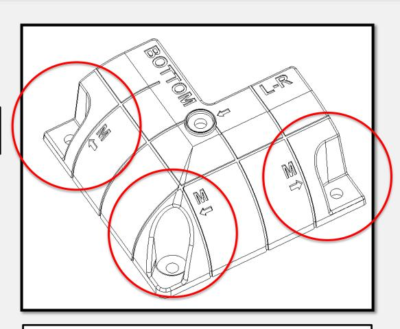
OVERLAY KIT SHOULD BE ASSEMBLED BY METRIC-4 SCREWS TO ONLY "M" MARKED HOLES ON PLASTIC PARTS.
